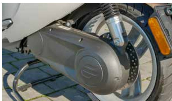
Centraal geplaatste motor, aandrijving wordt overgebracht door een snaar
