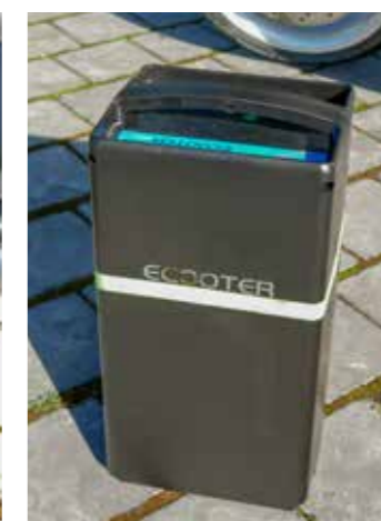
De sterke 60V/32Ah accu weegt 11,6kg
